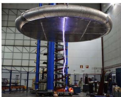
LCOE 1600kV超高壓測試
