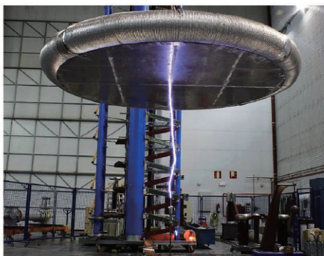
LCOE 1600kV超高壓實驗現場
